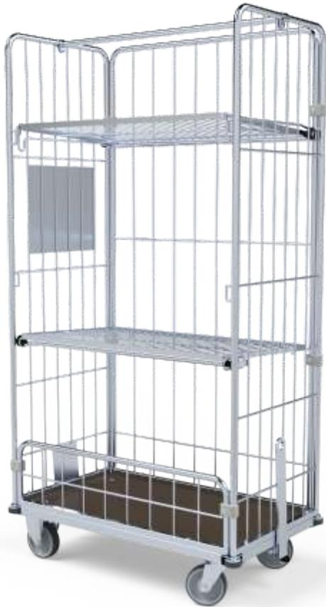
Die weiterentwickelte Version des **Bonn** wurde mit einer Kupplung & Deichsel ausgestattet, damit es dem Nutzer ermöglicht bis zu 3 Container hintereinander zu reihen und mit einem Zugfahrzeug über größere Distanz zu transportieren. Zusätzlich ist an der linken Seitenwand eine Blechtafel in der Größe 300x400mm befestigt, die auf Anfrage auch mit Tafellack bezogen werden kann. Alle weiteren Gegebenheiten des Bonn 4.2 sind übernommen worden.
